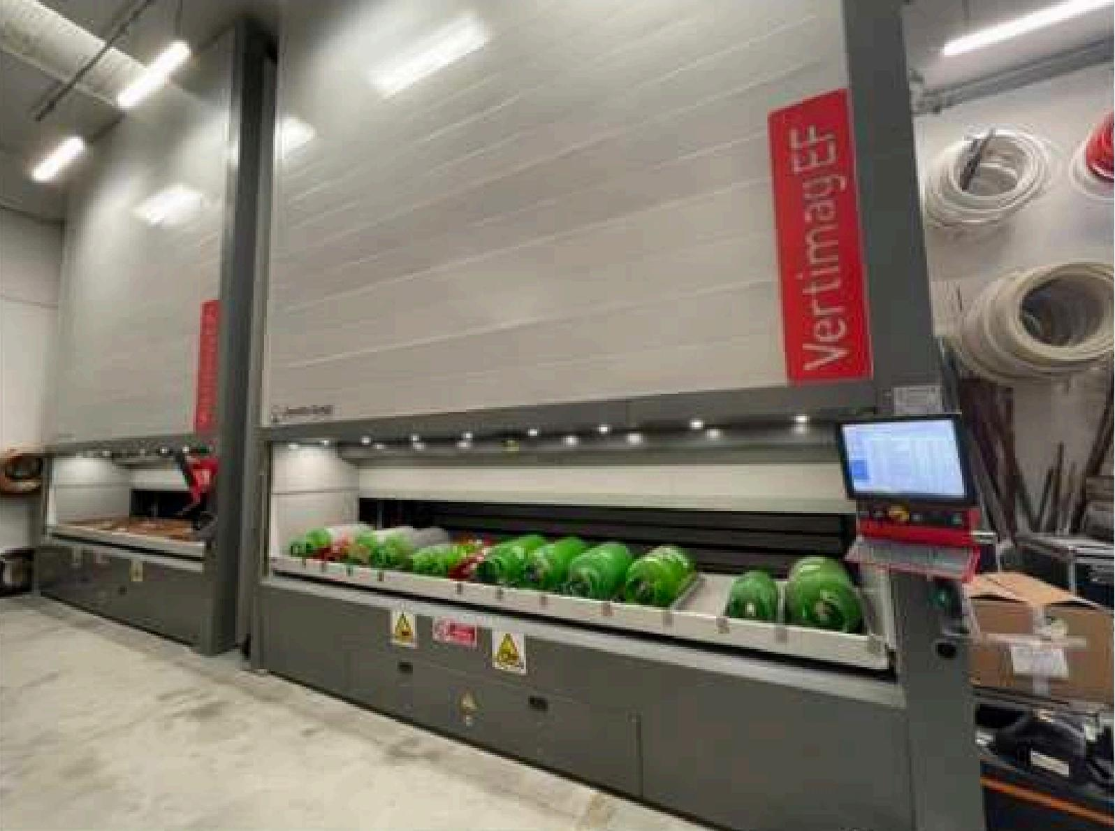
Tra gli asset produttivi fondamentali emerge un investimento importante che ha modificato radicalmente il processo produttivo del magazzino di A.M. Nel 2018 sono stati installati **due Vertical Lift Modules di Vertimag EF 84XL 800** presso la Sede di Asti. Trattasi, nello specifico, di due **magazzini verticali di ultima generazione** composti da due fronti di scaffali in cui sono alloggiati vassoi metallici (detti baie) movimentati da un elevatore.
